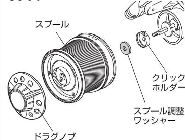
※スプールワッシャーの使用枚数は下記の巻糸状態調整方法を参照の上、調整してください。
